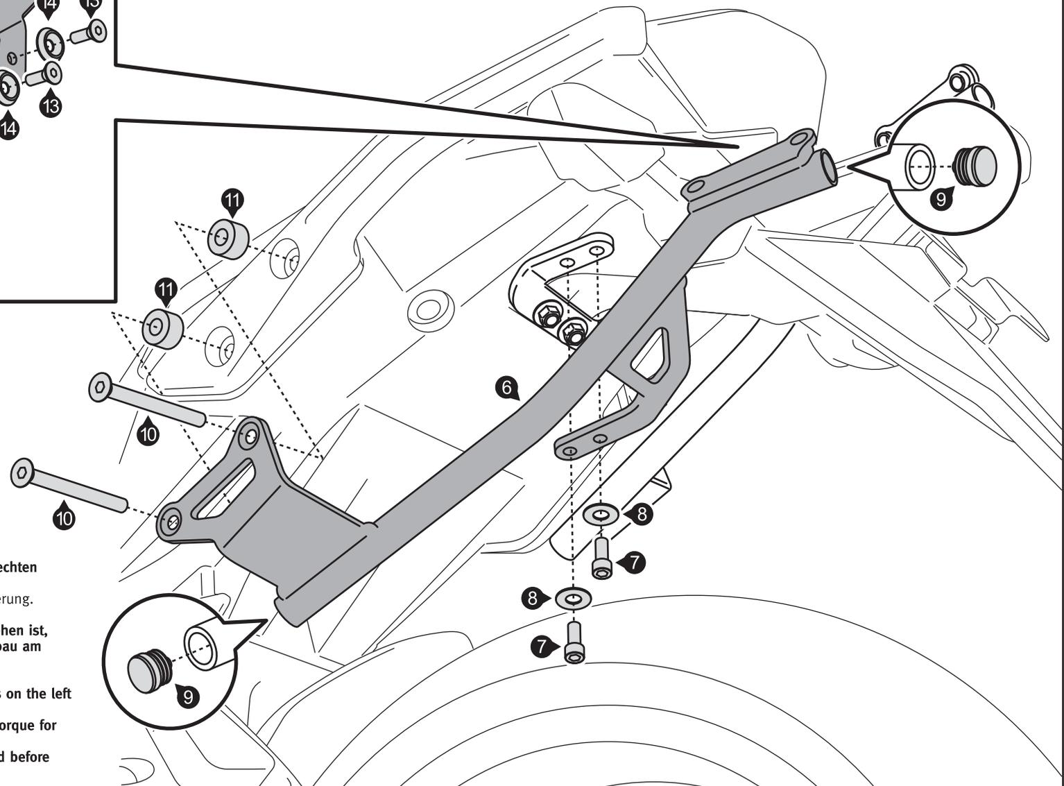
Die Montage der Unterbau-Streben (6) erfolgt auf der rechten Fahrzeugseite analog zur linken Fahrzeugseite. Sichern Sie alle Schrauben mit flüssiger Schraubensicherung. Anzugsmoment für die Schrauben (13): 20 Nm. Achtung: Falls die Montage einer Adapterplatte vorgesehen ist, MÜSSEN die Haltenocken am ALU-RACK vor dessen Anbau am Fahrzeug verschraubt werden.
